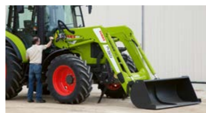
Завдяки мультимутфі MACH і системі FITLOCK вийти з кабіни потрібно лише один раз.
