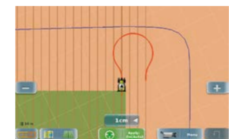
Система AUTO TURN автоматично розвертає трактор на краю поля.
