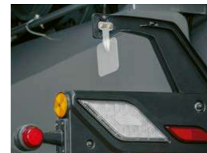
Датчик автоматичного регулювання напрямку розподілу.
