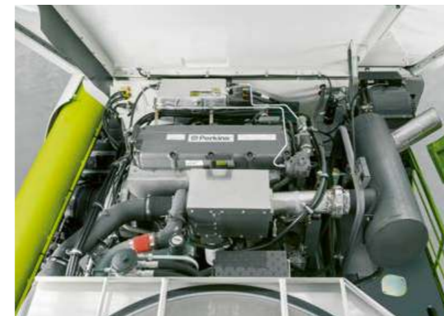
Perkins 2206D потужністю до 420 кВт / 571 к. с.
