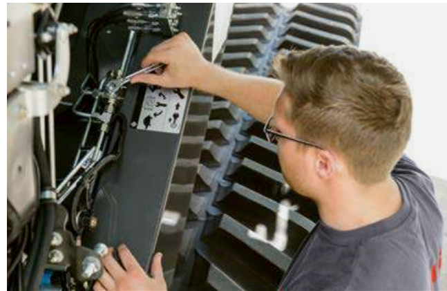
Перемикання двох діапазонів частоти обертання редуктора молотильного барабана виконується вручну за допомогою гідравлічного розподільника.
