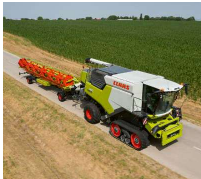
Усі машини з гусеничним рушієм TERRA TRAC придатні для руху по дорогах зі швидкістю до 30 км/год і більш комфортні в управлінні, ніж колісні машини.
