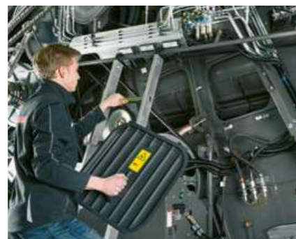
Багато точок кріплення для переносної драбини.
